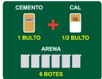
Se recomienda mortero tipo I, con proporciones 1:1/4:3 cemento:cal:arena, en volumen. (1 bulto de cemento, 1/2 bulto de cal y 6 botes de arena).
