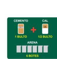
Se recomienda mortero tipo I, con proporciones 1:1/4:3 cemento:cal:arena, en volumen. (1 bulto de cemento, 1/2 bulto de cal y 6 botes de arena).
