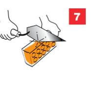
Las piezas mitades se pueden obtener cortando el tabique con disco o cuchara de albañilería. Con disco se logra mayor precisión y mejora el acabado.
