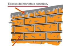
Se hará la limpieza del muro con un trozo de yute, trapo seco o cepillo con cerda de plástico y con movimientos horizontales para desprender los excesos de mortero o de concreto.
