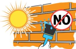
No aplicar el hidrofugante en condiciones de mucho sol.
