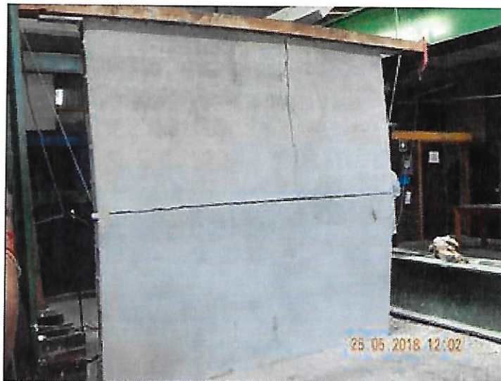
Figura 9. Condición de falla del muro 2 MEGABRICK 8 (20-50-8)
