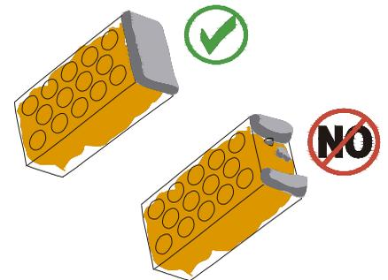
El Mortero de junteo deberá colocarse para el correcto pegado de las piezas, en toda la superficie (tanto juntas verticales como en horizontales), evitando el mal manejo de este únicamente en los extremos, con esto se garantiza la penetración del mortero en los alveolos de la pieza multiperforada.
