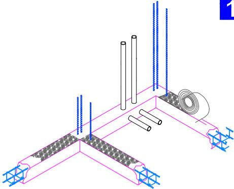
Se deberá contar con una impermeabilización previa al desplante de los muros para evitar contacto con la humedad del terreno, esto se realiza con diversos tipos de productos especializados que se encuentran en el mercado.
