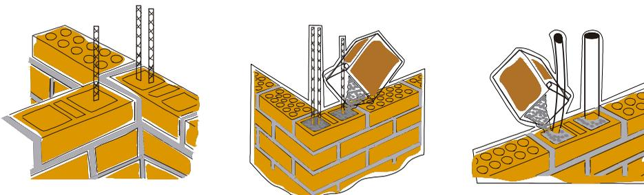
El ladrillo hueco se utiliza para ahogar castillos e instalaciones, asegúrese de rellenar completamente los castillos ahogados a cada 3 hiladas como máximo, se recomienda mortero tipo I, o la resistencia indicada en planos estructurales.
