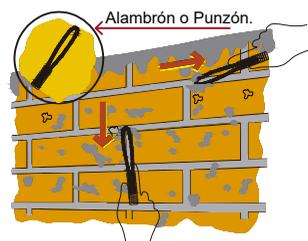
En muros aparentes, el marcado de las juntas se hace con un alambrón o "punzón" una vez colocadas de 4 a 6 hiladas de muro e inmediatamente después.
