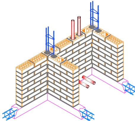
El sistema Novamuro es el resultado de la combinación de 2 piezas, "Multiperforada" + "Hueca", en donde la pieza hueca se utiliza para el ahogado de castillos e instalaciones, y la pieza multiperforada será la que nos aporte la resistencia estructural necesaria para la estructura.
