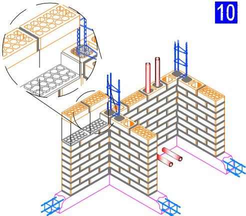
El mortero debe penetrar en los alvéolos entre 5 y 8 mm como mínimo, esto para formar los "pernos de cortante" que traban internamente los tabiques ante movimientos horizontales.
