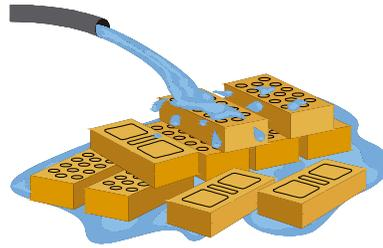
Los tabiques deben ser mojados a saturación conforme lo indique la normativa vigente para lograr una adecuada adherencia con el mortero y lograr una mampostería homogénea.
