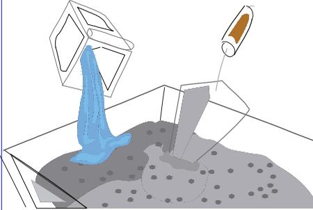
El mortero que se prepare en obra, se debe consumir en un lapso no mayor a 1 hora, evitando el mal uso de este usando más agua para su reblandecimiento. (a mayor cantidad de agua, menor resistencia del mortero)
