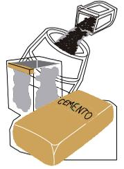
Se recomienda mortero tipo I (resistencia 125 kg/cm<sup>2</sup>, con proporciones 1:3 cemento:arena, o en volumen. (1 bulto de cemento y 6 botes de arena), en caso de usar algún mortero premezclado o mortero de albañilería, consultar al fabricante para garantizar la resistencia mencionada (consultar planos y especificaciones estructurales)
