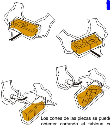
Los cortes de las piezas se pueden obtener cortando el tabique con cuchara de albañilería, se recomienda estén húmedas para facilitar el corte con ésta, también es opción con disco, se logra mayor precisión y mejora el acabado.
