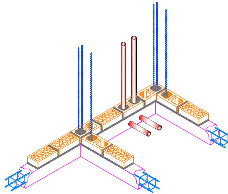
Colocación de la primera hilada de tabique después de impermeabilización pegado con mortero, colocar hilos y reventones para cuidar la uniformidad de juntas tanto vertical como horizontal.
